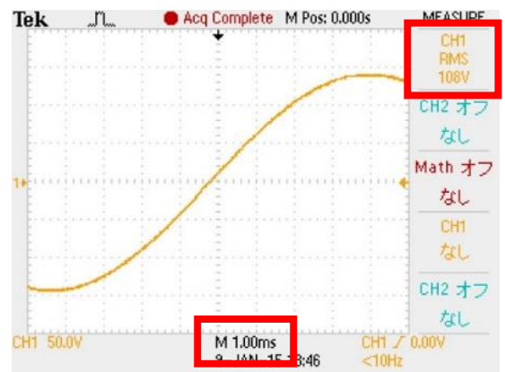
図 7. 不適切な表示例 (横軸レンジ小)
